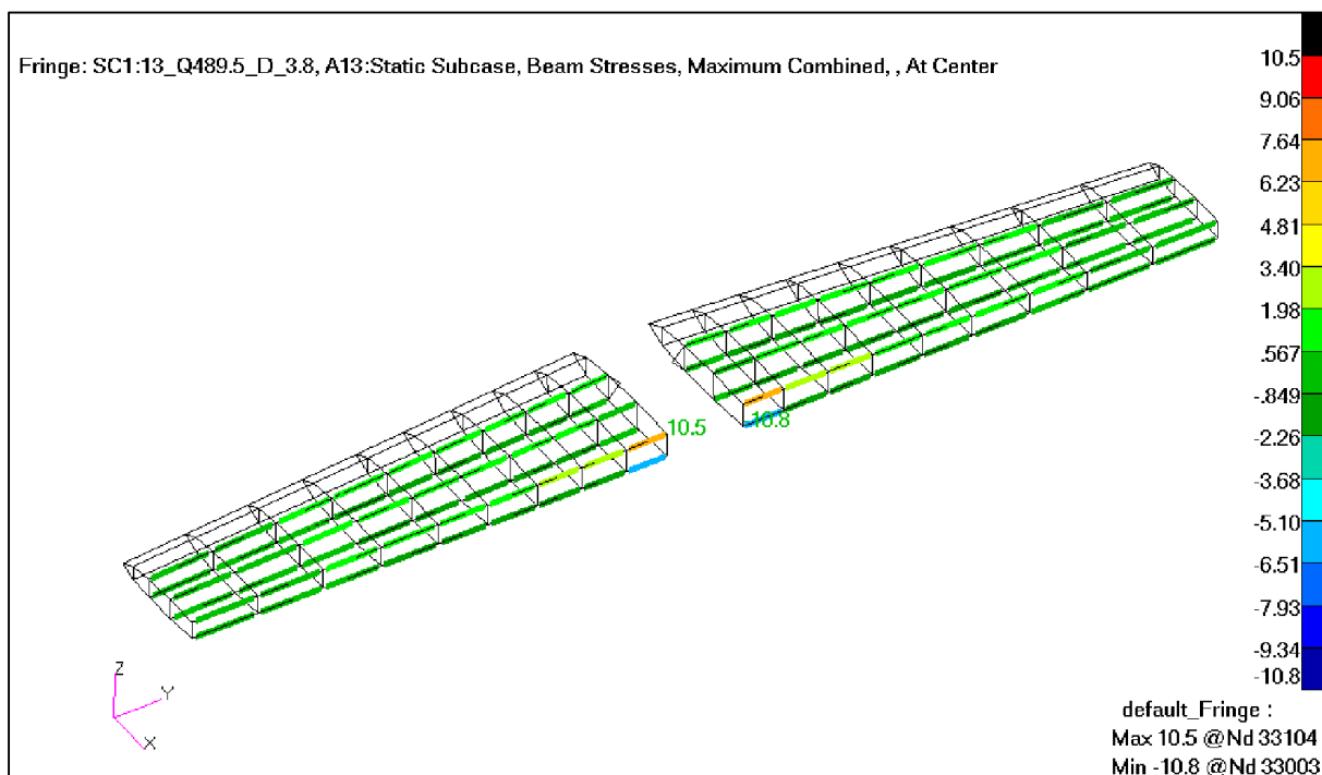
Rys. 393. Przypadek 13. Naprężenia od zginania i rozciągania/ściskania w pasach i podłużnicach usterzenia poziomego (kG/mm 2 ). [20]
