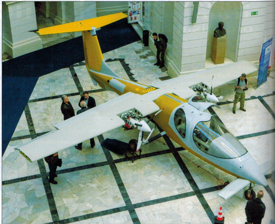
Płat nośny jest integralny, komora chowania podwozia i dźwigar główny nie zabierają miejsca w kabine
